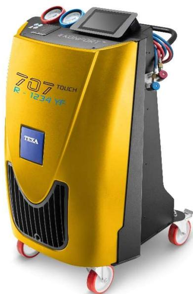
KONFORT 707 TOUCH completa di display touch 7" con interfaccia utente dedicata, serbatoio refrigerante da 10kg, pompa a vuoto 100 lt/min, connettività Wifi e Bluetooth.
